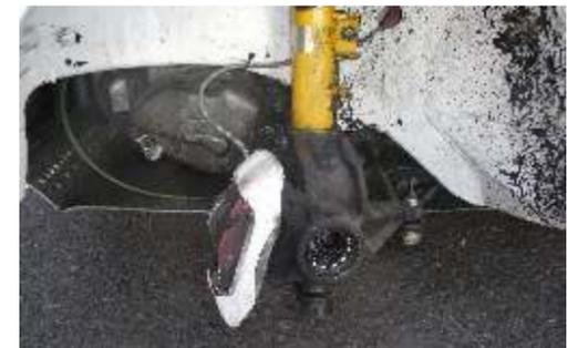
El rodamiento del buje y la punta del palier maltrechos
